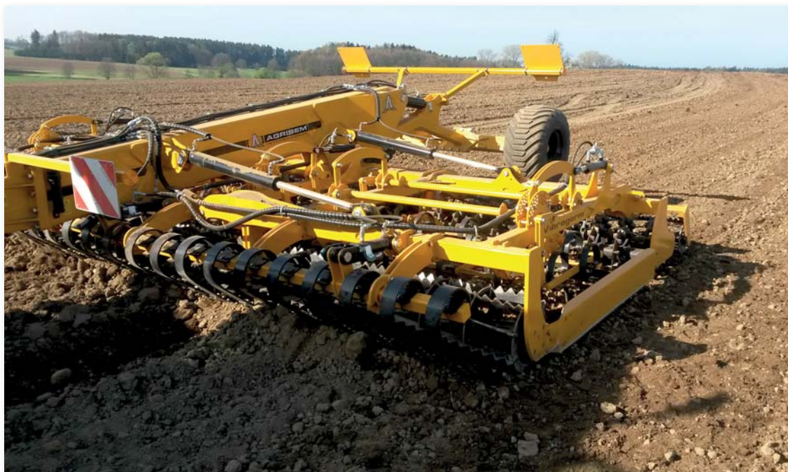
► Obsluha stroje velmi oceňuje práci přední, nezávisle zavěšené a z kabiny traktoru hydraulicky ovládané smykové lišty
