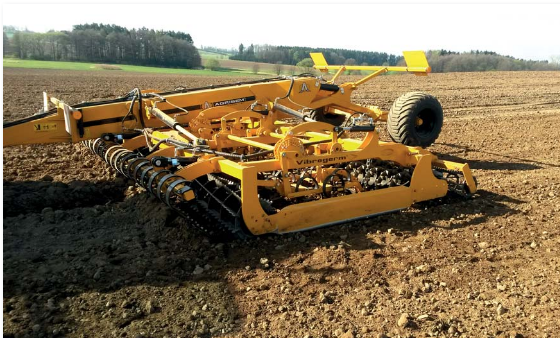
► Kompaktor Vibrogerm má velmi robustní konstrukci a hmotnost 7 t
